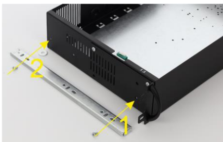
Przykręć prowadnice dwoma śrubami do obudowy ARAD (pamiętaj o podkładce dystansowej pod drugą śrubą)
