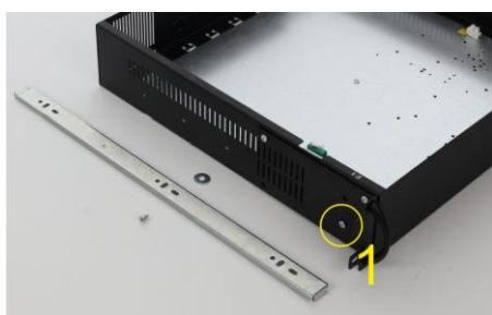
Odkręć pierwszą śrubę M4 z obudowy ARAD
