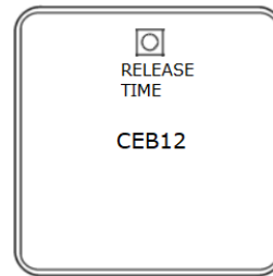
Rys. 3 Lokalizacja przycisku programującego czas załączenia wyjścia elektronicznego
