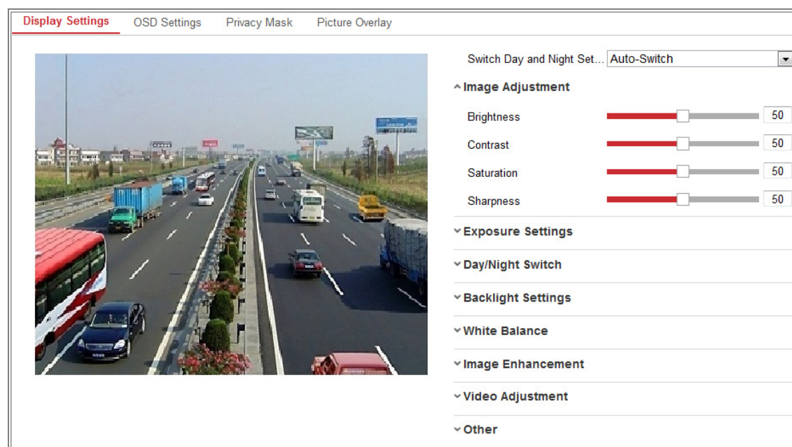
Rysunek 9–1 Ustawienia wyświetlania automatycznego przełącznika trybu dzień/noc
