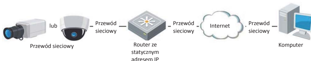
Rysunek 2–10 Uzyskiwanie dostępu do kamery przy użyciu routera ze statycznym adresem IP
