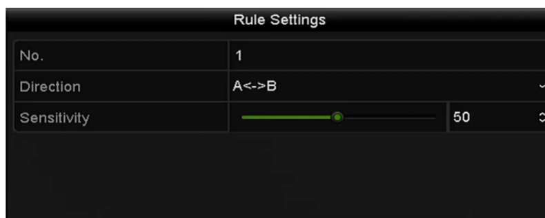
Figure 9.5 Ustawianie reguł wykrywania przekroczenia linii
