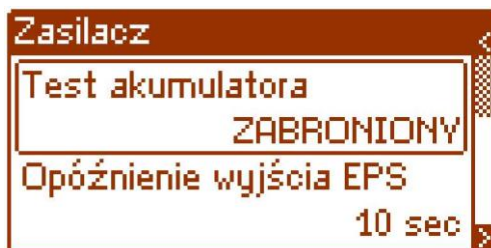
Rys. 29. Test akumulatorów – „ZABRONIONY”.
