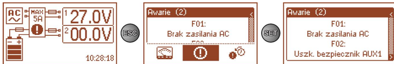
Rys. 19. Ekran – bieżące awarie zasilacza.
