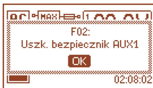
Rys. 18. Komunikat sygnalizujący przepalenie bezpiecznika na wyjściu AUX1.
