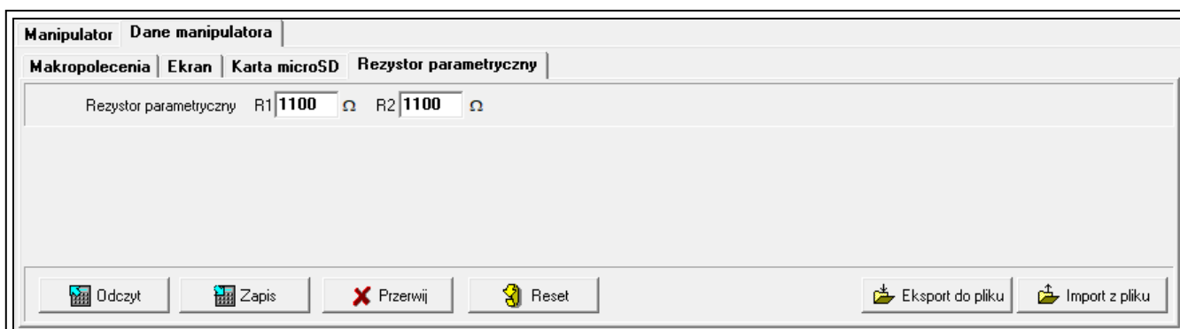
Rys. 27. Program DLOADX: zakładka „Rezystor parametryczny” (ustawienia fabryczne).
